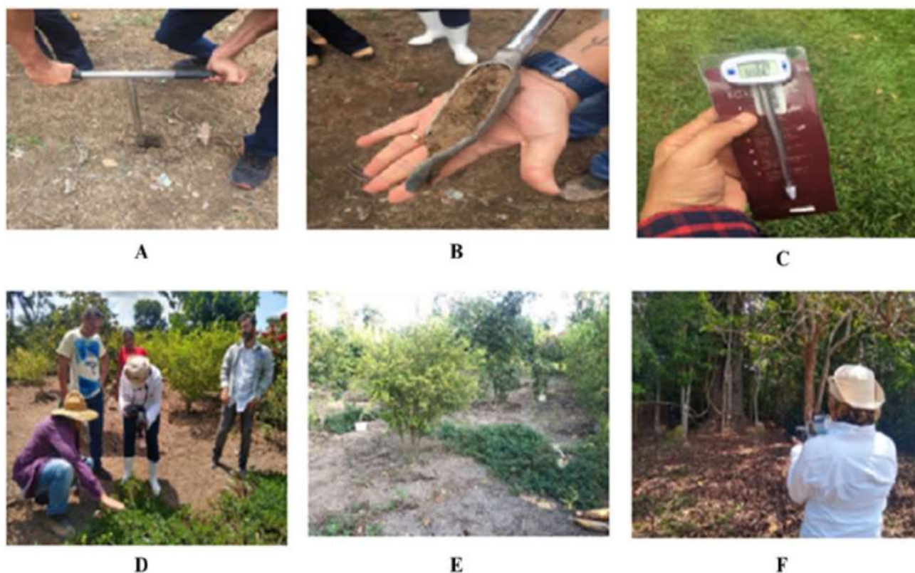
Figura 3 Imagens fotográficas durante as coleta de dados em campo para exemplificar as condições no solo na Unidade de Referência Tecnológica: A. e B. solo após a gradagem para avaliar cor, textura, umidade nos pontos de coletas dos termogramas; C. indicativo de umidade do solo com o sensor de umidade; D. coletas com a câmera termográfica no infravermelho próximo para avaliar padrões nos alvos sob condição irrigada pelos potes de argila e fora da URT; E. disposição dos potes no sistema IrrigaPote; e F. coleta termográfica na área de remanescente floreal na área do produtor rural
