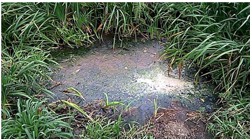
Figura 3: Unidade Agroindústria – Colmatção e tratamento ineficiente. Fonte: Autor.
