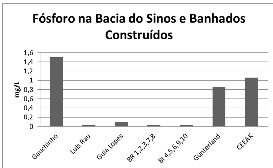
Figura 13: Concentrações para Fósforo nos locais amostrados.
