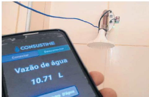
Para utilizar a ferramenta, basta que o usuário conecte um smartphone ao chuveiro via bluetooth e, com isso, passe a ter o controle em tempo real da quantidade de água gasta. FOTOS: MARCELINO JÚNIOR
